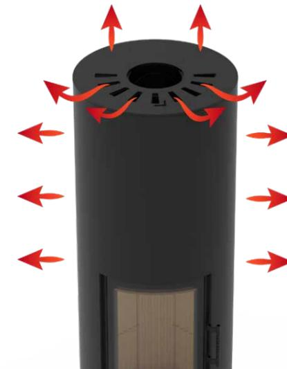
Wird die Deckelplatte geöffnet, erhöht sich der Konvektionsanteil um die effektive Raumheizleistung zu erhöhen.
